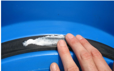
Enduire le joint avec le lubrifiant.
