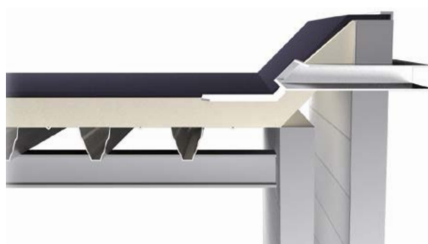
Figure 2.3: Coupe transversale d'un trop-plein de secours
